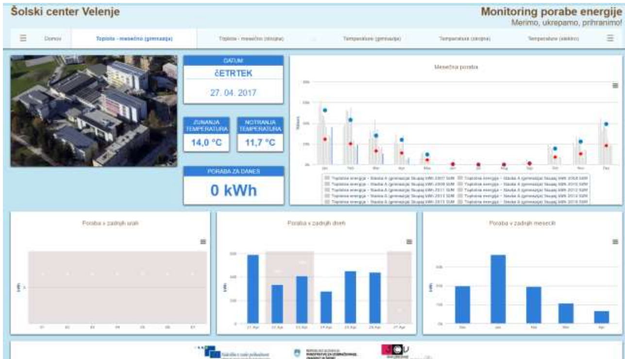
Slika 9: Primer uporabniškega vmesnika za upravljanje energije glede na povpraševanje, ki prikazuje podatke o mesečni, tedenski, dnevni, urni in trenutni porabi energije 6
