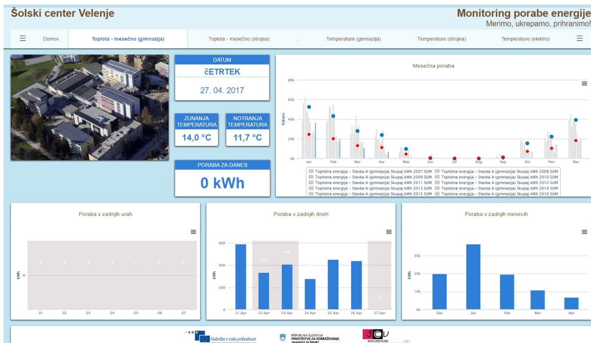
Figura 11: un esempio di interfaccia che presenta dati informativi, dati riguardo al consumo energetico mensile, settimanale, giornaliero, orario e attuale 10
