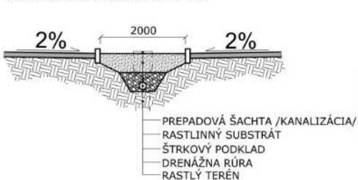
VSAKOVACÍ VEGETAČNÝ PÁS M 1:50
