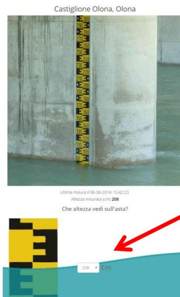
Inquadrando il codice QR con la fotocamera dello smartphone, l'utente è indirizzato direttamente alla maschera della stazione in cui inserire il livello idrico appena letto (in cm) tramite un menù a tendina (senza dover digitare numeri per minimizzare gli errori di battitura).
