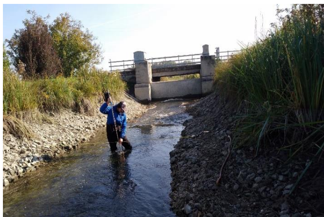
Fig. 20. Water flow measurements (A.Šoltész).
