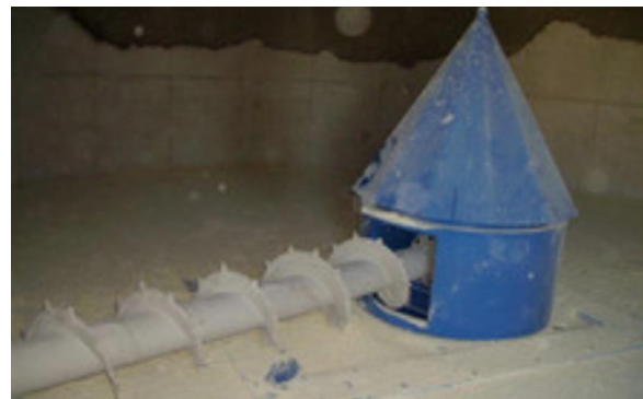
Figure 6.26 Milling screw (source: JPA Fördertechnik).
