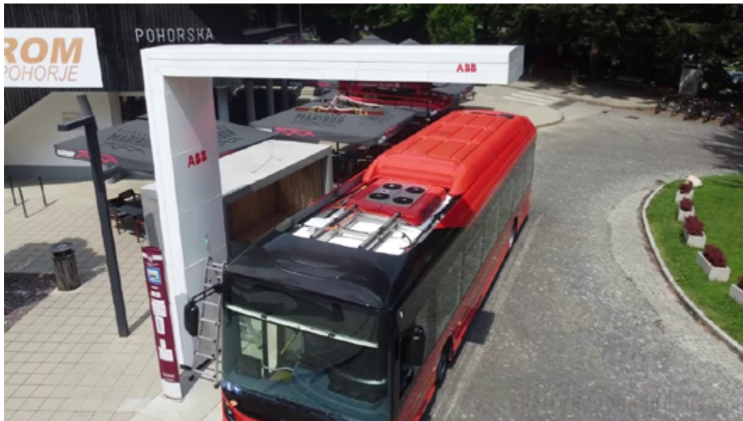
Abbildung 21: Der installierte Stromabnehmer wird mit dem gekauften Bus getestet
