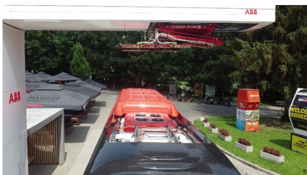
Obrázok 21: Nainštalovaný pantograf sa testuje so zakúpeným autobusom
