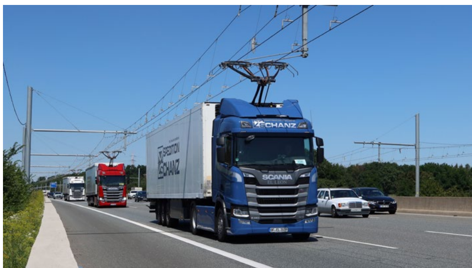
Rysunek 16: Pas testowy elektrycznej autostrady ELISA 2020. Źródło: M. Werner (TU Dresden)
