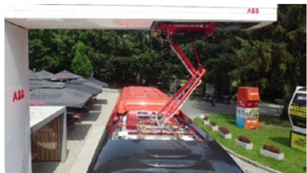
Abbildung 22: Demonstration der Funktionsweise des Stromabnehmers
