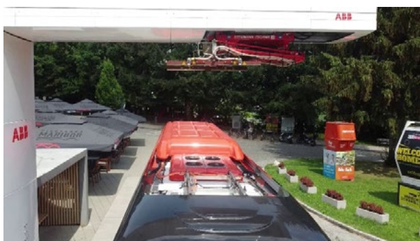
Rysunek 21: Zainstalowany pantograf testowany z zakupionym autobusem
