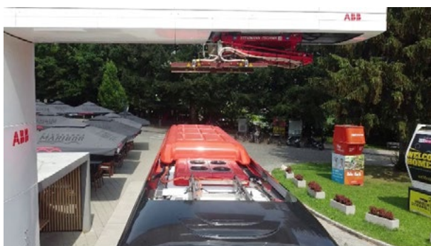
Figura 21: Pantografo installato in fase di collaudo con l'autobus acquistato
