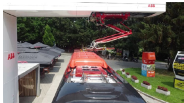
Abbildung 21: Der installierte Stromabnehmer wird mit dem gekauften Bus getestet
