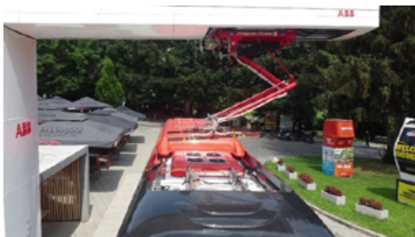
Abbildung 22: Demonstration der Funktionsweise des Stromabnehmers
