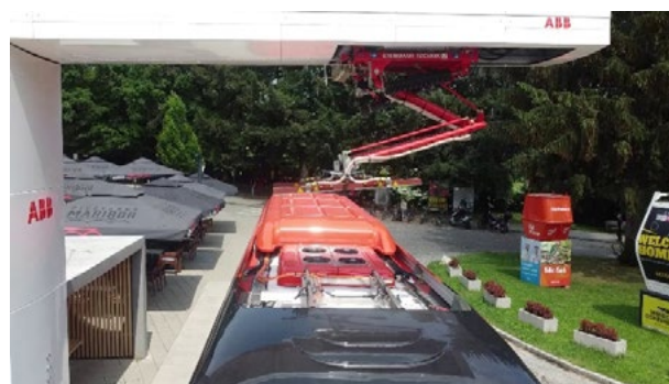
Rysunek 21: Zainstalowany pantograf testowany z zakupionym autobusem
