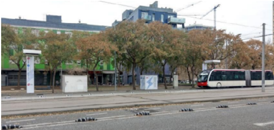
Abbildung 11: Stromabnehmeraufladung in Barcelona als Teil eines ehrgeizigen Elektrifizierungsplans. Quelle: TMB.
