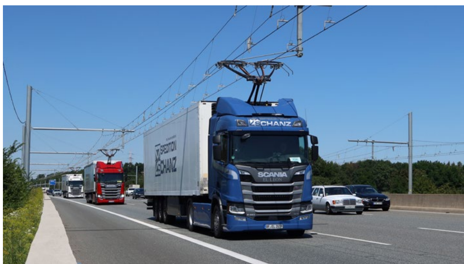
Figura 16: Percorso di prova dell'autostrada elettrica nell'ambito del progetto ELISA del 2020. Fonte: M. Werner (TU Dresden)
