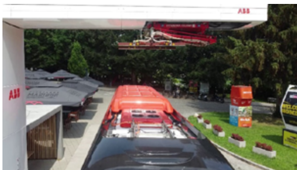
Abbildung 21: Der installierte Stromabnehmer wird mit dem gekauften Bus getestet
