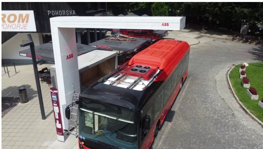
Obrázok 21: Nainštalovaný pantograf sa testuje so zakúpeným autobusom
