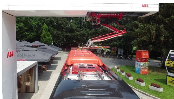
Slika 20: Ugrađeni pantograf ispituje se zajedno s kupljenim autobusom
