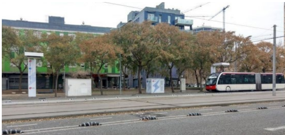
Obrázek 11: Nabíjení pantografovým sběračem v Barceloně jako součást ambiciózního plánu elektrifikace. Zdroj: TMB.
