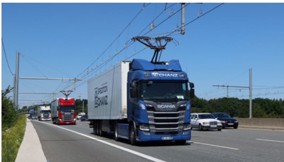
Abbildung 16: E-Highway-Teststrecke ELISA 2020. Quelle: M. Werner (TU Dresden)
