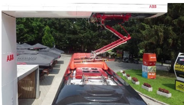
Figura 22: dimostrazione del funzionamento del pantografo
