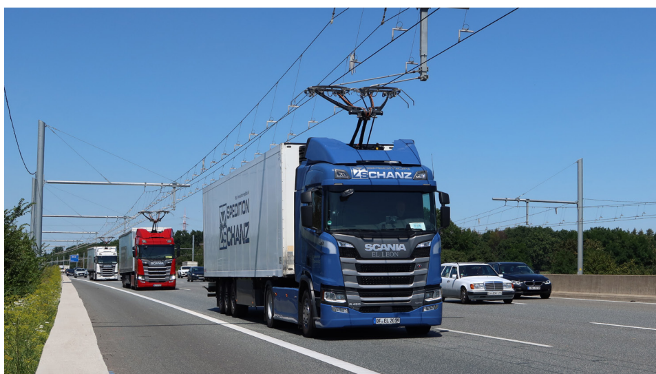
Obrázok 16: Skúšobná trať elektrickej diaľnice ELISA 2020. Zdroj: M. Werner (TU Dresden)
