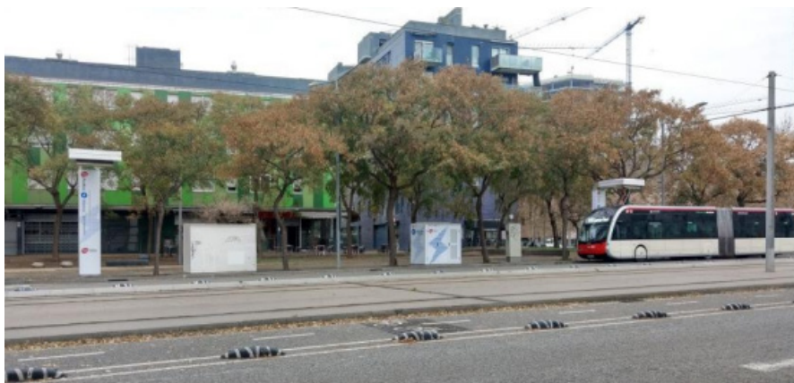
Obrázok 11: Nabíjanie pomocou pantografu v Barcelone ako súčasť ambiciózneho plánu elektrifikácie. Zdroj: TMB.
