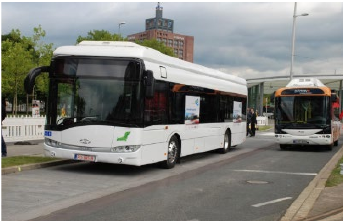
Rysunek 15: Autobus elektryczny z indukcyjnym ładowaniem w Brunshwiku. Źródło: Rupprecht Consult.
