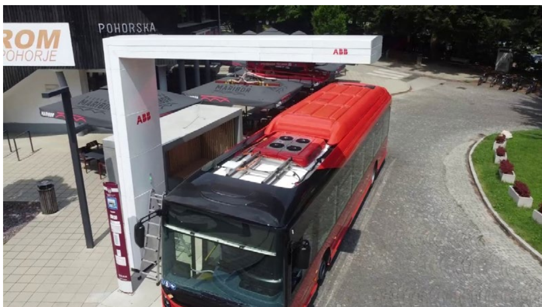
Figura 21: Pantografo installato in fase di collaudo con l'autobus acquistato
