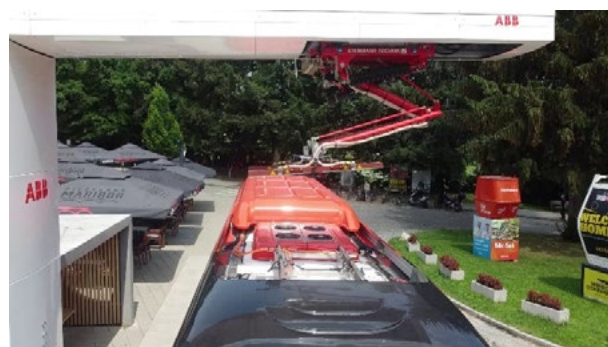
Figura 21: Pantografo installato in fase di collaudo con l'autobus acquistato
