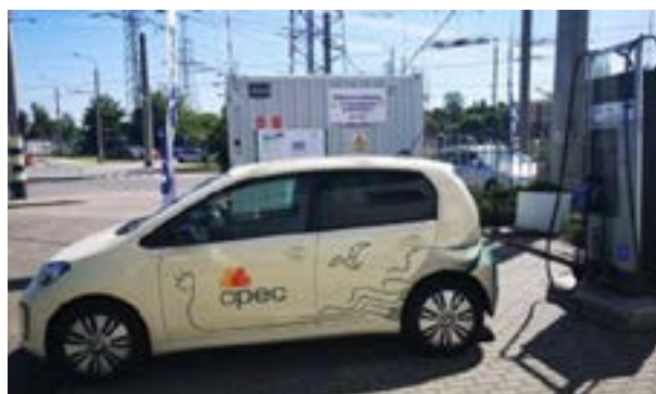
Obrázek 6: Mobilní nabíjecí stanice pro elektrická vozidla napájená trolejbusovou sítí (PKT)
