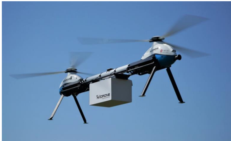
Obr. 29: Vizualizace nákladního dronu společnosti AVIDRONE přepravující kontejner
