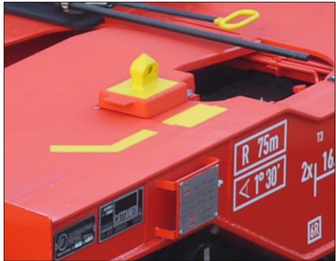
Abbildung 9: oberer Eckbeschlag (Corner castings, links) und Drehverschlüsse (Twistlocks, rechts) 2
