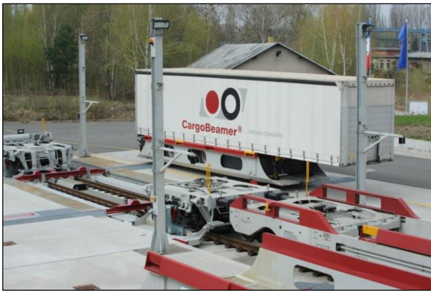
Abbildung 16: Das System CargoBeamer 8
