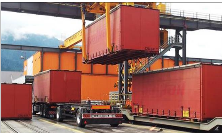
Abbildung 12: Greifzangen-Umschlag von Wechselbehältern 5
